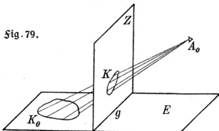
man das Bild  $K$  von  $K_0$  auf  $Z$  aufzeichnen kann. Das ist aber das Verfahren der Zentralprojektion.  $K$  heißt deshalb der Zentralriß von  $K_0$ , und  $A_0$  wird der Augenzentrum genannt.  $E$  ist die Grundebene und die Schnittgerade  $g$  von  $Z$  und  $E$  die Grundlinie. Auf der Grund-
