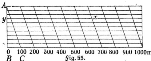
man mit einem Maßstab, wie ihn Fig. 55 zeigt. Man betrachte darin das Dreieck ABC. Die Höhe AB ist in zehn gleiche Abschnitte geteilt. Da  $BC = 100\text{ m}$  ist, so ist jeder der parallelen Teilstriche um  $\frac{1}{10} \cdot 100 = 10\text{ m}$  kürzer als der vorhergehende. Die Maße von unten nach oben sind daher 100 m, 90 m, 80 m usw., 10 m. Sollen z. B. 730 m abgemessen werden, so geht man auf der 700-Linie nach oben bis zum dritten Teilstrich. Also ist  $XY = 730\text{ m}$ .
