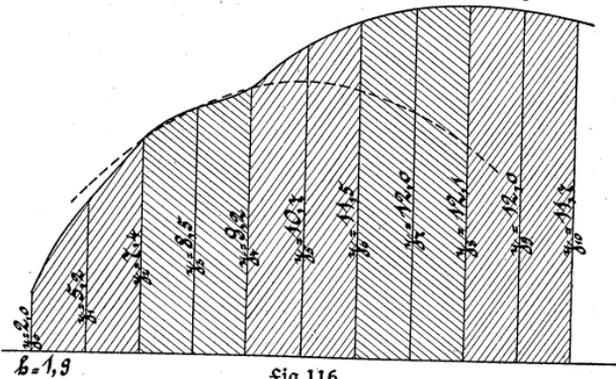
lischen Mathematiker Simpson, der sie zuerst angab, benannt worden ist. Die ganze Fläche teilt man gerade so wie vorher in Streifen ein, aber man faßt je zwei Streifen, wie in der Fig. 116 durch Schraffierung angedeutet ist, zusammen. Jeder Doppel-
